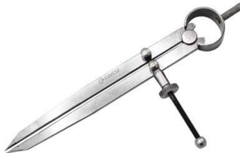
پرگار اندازه‌گیر: برای انتقال اندازه‌ها
